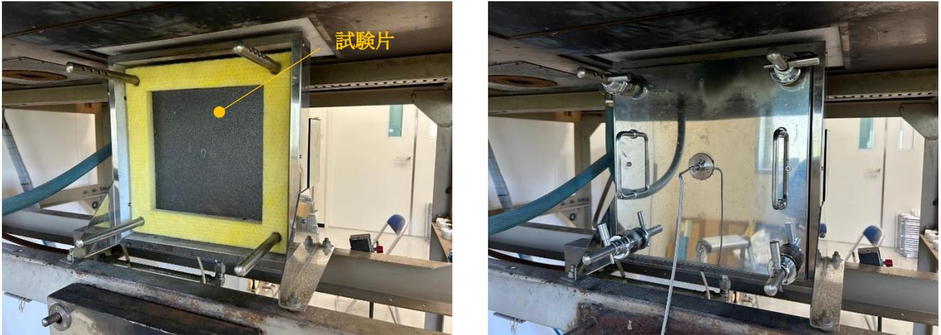
図 表面燃焼試験装置に装着された試験片（左）と裏蓋を閉じた状態（右）の外観写真
