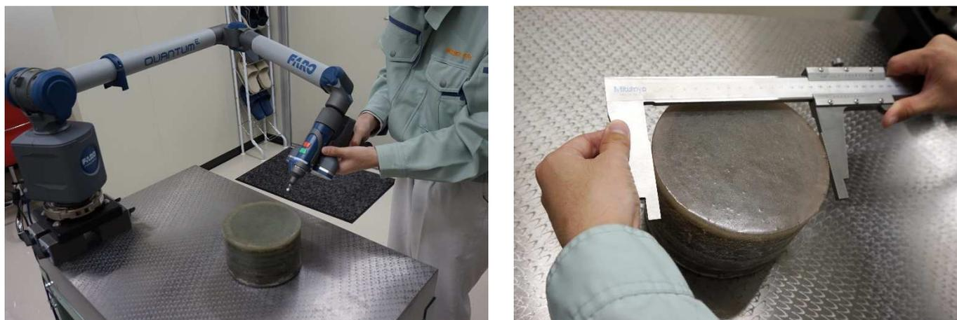
図 寸法検査の様子（左：直角度/円筒度 右：直径）
